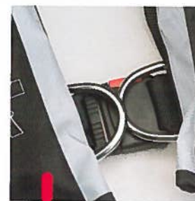
4. De kunststof sluiting is niet sterk genoeg. Een lifeline moet dan ook aan beide ogen worden aangehaakt.
