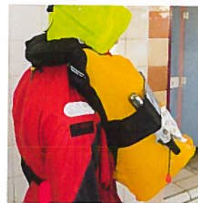
5. De buitenhoes van dit reddingvest wil maar niet volledig openen: geen drijfvermogen in de nek.
